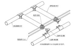
●ローラーコンベア用部材(DP3210-4-Y等)をモーター等の動力で動かす際に使用します。
