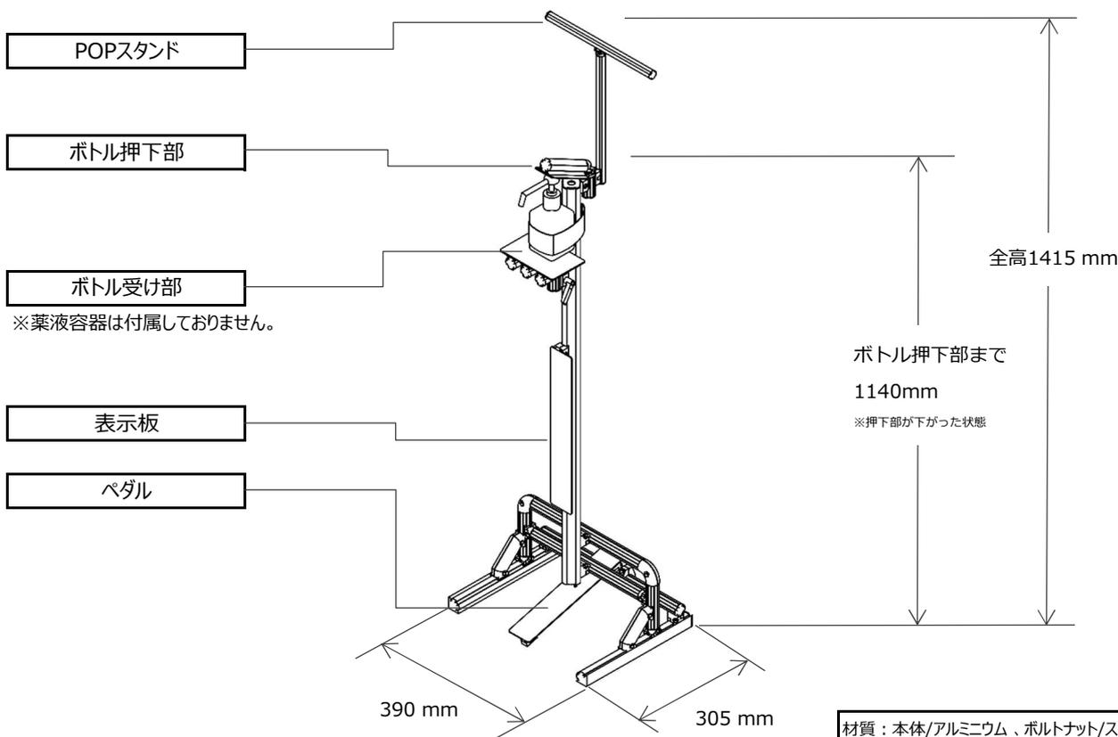
材質：本体/アルミニウム、ボルトナット/スチール
