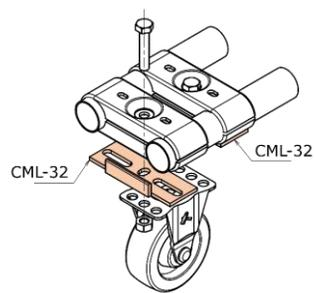
●天秤台車の製作やフロアロック取付けの際に、キャスター取付け高さの調整に使用します。(3.2mm厚)
