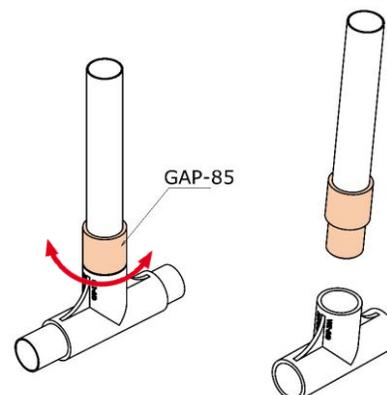
●回転用(ヒンジ用)ジョイント。凸側は溶着せず、他のプラスチックジョイントに差し込んで使用します。
