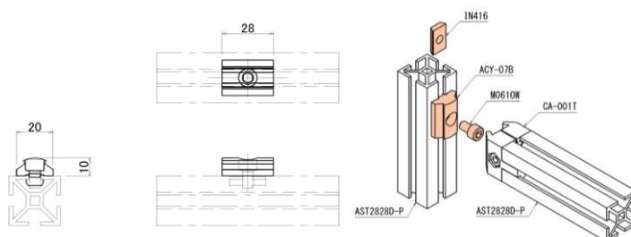
●スクエアアルミパイプの溝を使用して、アルミジョイントセットを取付ける場合に使用します。
