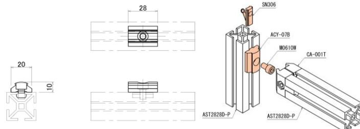
●スクエアアルミパイプの溝を使用して、アルミジョイントセットを取付ける場合に使用します。
