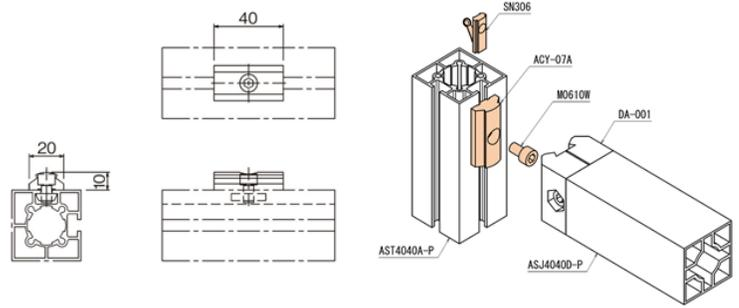
●スクエアアルミパイプの溝を使用して、アルミジョイントセットを取付ける場合に使用します。
