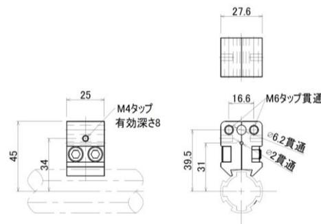
●ロープの取付けや微調整、パネル・スライドレールなどパーツを取付ける際に使用します。
