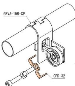
※CPD-32を取付ける際は、滑車に付属しているスプリングワッシャーM6は取り外してください。
