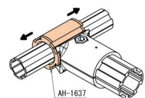
●φ19アルミパイプを通し、外側にφ28アルミパイプを連結することができます。
