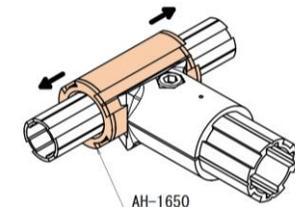
●φ19アルミパイプを通し、外側にφ28アルミパイプを連結することができます。
