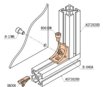
●側面にM6タップ加工がされており、厚さ3mmまでのパネル取付けに対応します。
