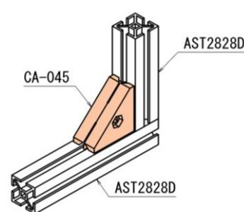
●28スクエアアルミパイプAST2828Dの溝を使用してパイプを連結することができます。
