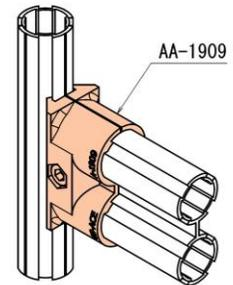
● φ19アルミダブルパイプ固定用のアウタージョイントです。
