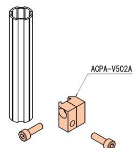
● φ19アルミパイプに小物などパーツを垂直に取付ける際に使用します。
