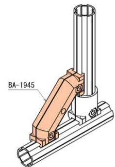
● φ19用の補強ジョイントです。パネル等を固定できるようにセンターホールにM5ナットが内蔵されています。
