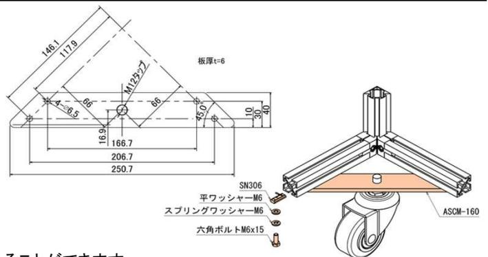
●28スクエアパイプ使用時にボルトタイプキャスターを取り付けることができます。
