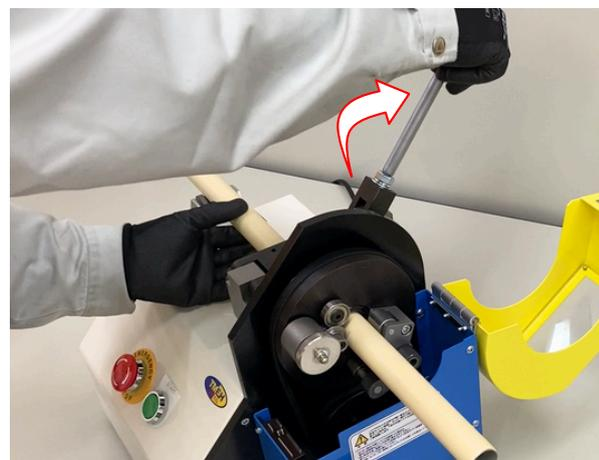
4. パイプの印と刃が重なるように位置を合わせ、パイプクランプでしっかり固定します。
