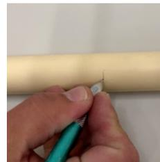
2. パイプのカットしたい寸法の位置に印を付けます。
