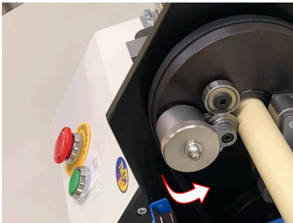
5.刃送り調整ネジを矢印の方向に回し、摘みが止まるまで締めます。
